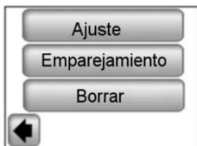
1. Ponga la antena adicional RF de su módulo GSM en el régimen de emparejamiento (RF init) manteniendo presionada la tecla RF durante 3 segundos. El diodo LED en la antena empieza a emitir la luz verde. A continuación presione el botón de "Emparejamiento" en su unidad central, con lo cual se realiza el emparejamiento de las dos unidades.
