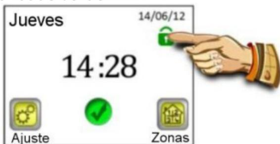
En la siguiente pantalla bloquee la pantalla manteniendo presionada durante 5 segundos la tecla "Bloquear".
