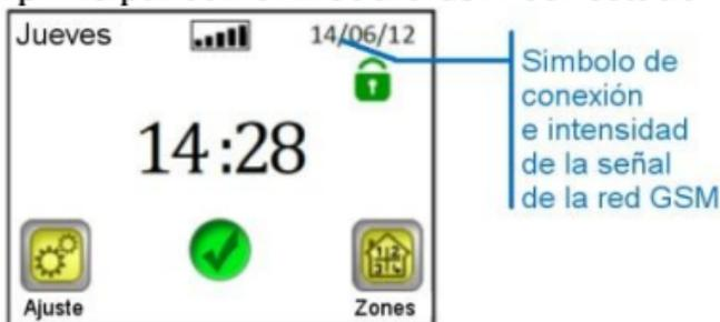
Ajuste de la comunicación GSM es posible solamente con el módulo GSM V27 conectado (por cable o de manera inalámbrica).
