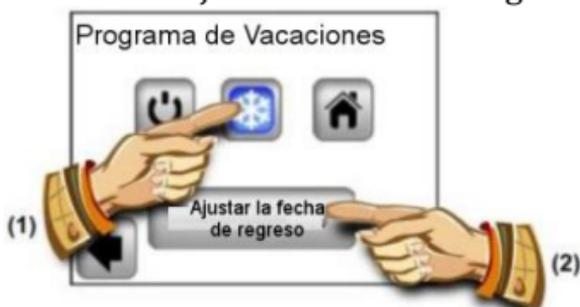
Para ajustar la fecha de regreso presione la tecla (OK) en la parte inferior de la pantalla, con lo que confirmará y terminará el ajuste – en la pantalla se ve el régimen elegido (Apagado/régimen anticongelante) y la fecha de su final.
