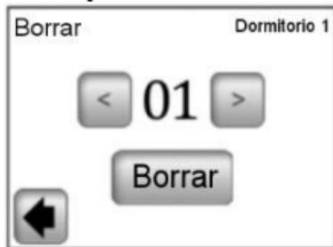
Seleccione con ayuda de las teclas (<) o (>) la zona destinada a eliminar y presione la tecla "Borrar". Para evitar la eliminación indeseada de la zona, se requiere la confirmación de la orden de borrar presionando la tecla "Sí".
