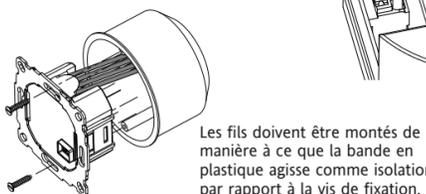
Les fils doivent être montés de manière à ce que la bande en plastique agisse comme isolation par rapport à la vis de fixation.
