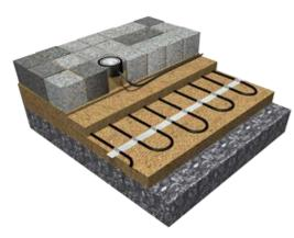
нагревательный элемент в бетонном основании, которое будет предохранять кабель от повреждения при нагрузке, возникающей при проезде автотранспорта по этим коммуникациям.
