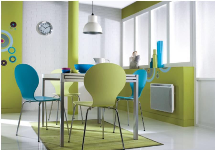
Ce phénomène est supprimé par les convecteurs rayonnants, parce que leur construction permet la transmission à peu près de 50 % de l'énergie thermique par rayonnement, et à peu près de 50 % de l'énergie par convection. Comme cela l'excellente dynamique de chauffage est conservée et en même temps les charpentes sont réchauffées par rayonnement du convecteur. C'est pourquoi leur exploitation est beaucoup plus confortable et ils devraient être préférés dans les pièces d'habitation.
