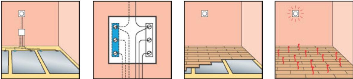
Pour le réglage on peut utiliser un thermostat adéquat avec la sonde de sol, offert par la société FENIX. Le réglage maintient la température du sol au niveau réglé en le protégeant contre un surchauffage éventuel. En utilisant le thermostat digital, on peut programmer la marche du chauffage. Avec intention, le réglage ne fait pas partie du jeu – en achetant plusieurs jeux pour une pièce, l'utilisateur achèterait plusieurs thermostats, dont il n'aurait pas besoin.
