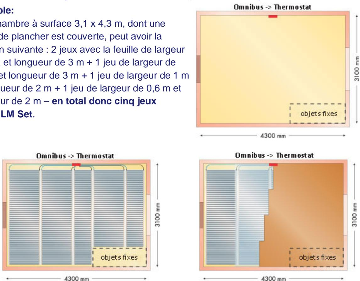
Amener les fils de raccordement de chaque bande à la boîte et les brancher à la planche à bornes. Chaque jeu (bande de feuille) a deux fils conducteurs – l'un noir et l'autre bleu.
